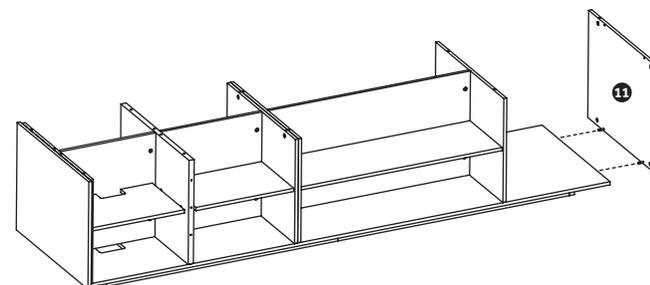
**Obs:** Após fixar a lateral externa arm/gav(11), ficará um "dente" para um dos lados, esse dente será o vão do puxador do gaveteiro. A lateral(11) pode ser fixada dos dois lados, deixando o dente para frente ou para trás, isso definirá o lado do armário (esquerdo ou direito) para utilização em conjunto com a mesa.
