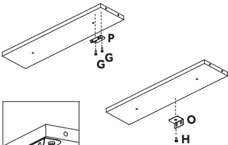
Fixar a chapa trava paralelamente a face frontal do montante.
