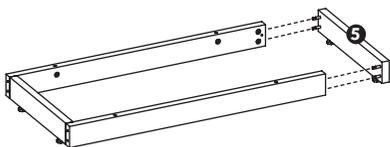
Fixe as outras 2 frontais do rodapé(7), na outra lateral(5), com os minifix(A),(B) aplicados na pré-montagem. Fixe as chapas L(O), com os parafusos 4,8x13(H) nas extremidades das frontais do rodapé.
