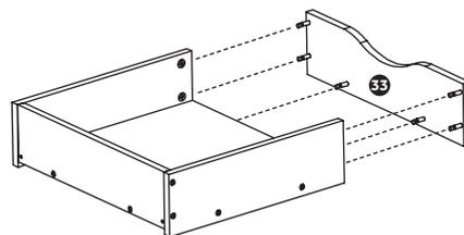
Parafuse o conector das corredeiras na frente e na base da gaveta porta objeto, utilizando os parafusos 4x14(G).
