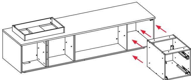
Deixe o corpo do gaveteiro faceado à lateral interna(16) e a base(2) do armário. Por dentro, faça a fixação com os parafusos 3,5x25(F), pelos furos dos montantes, laterais e base.
